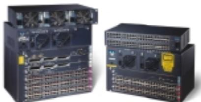
Коммутаторы Cisco, поддерживающие технологию подачи питания по стандартной витой паре категории 5, используют для подачи энергии (6.3 Вт) от коммутатора пары 2 и 3 (разъемы 1, 2, 3 и 6). Этот метод обеспечения питания иногда называют фантомным, поскольку силовые сигналы проходят по тем же двум парам, что используются для передачи сигналов Ethernet.
